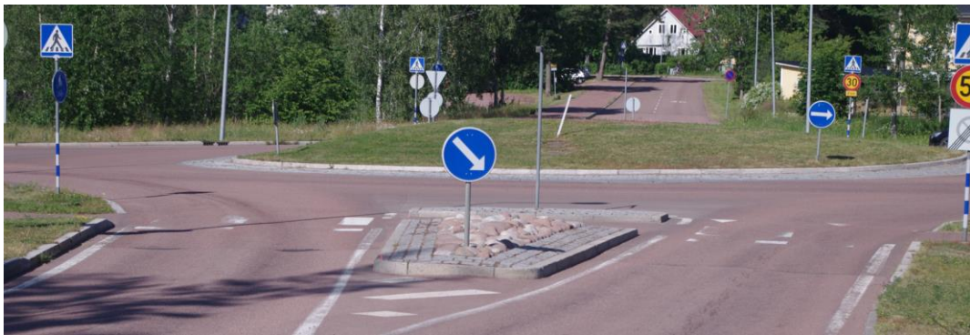
Exempel på gatudetaljer - refug till skydd för gc-led
